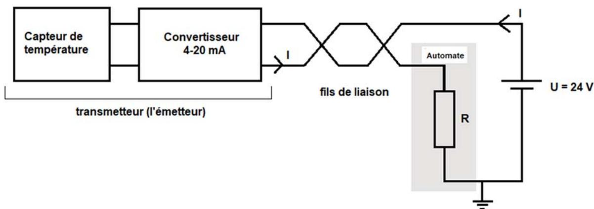
Le transmetteur 4-20 mA permet de convertir (adapter) une grandeur analogique (ici une température) en un courant  $I$  pouvant varier entre 4 et 20 mA.
