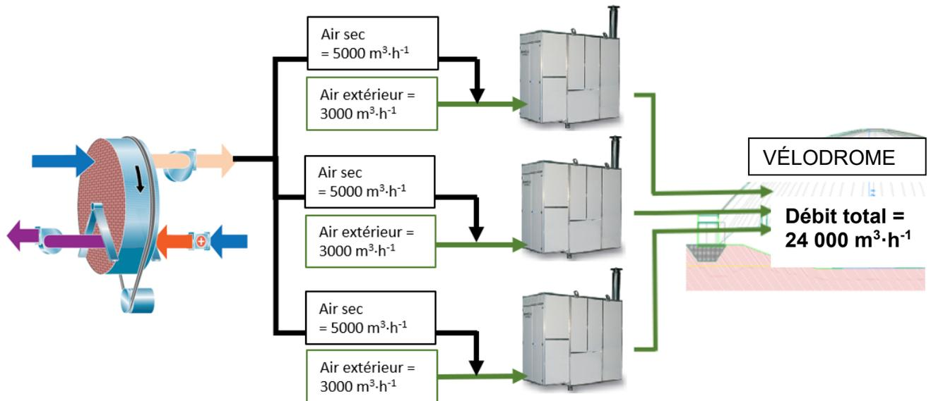
Question 5.1 | Sur le diagramme de blocs internes de la roue déshydratante (DR5), identifier les deux flux d'air en repassant sur les traits avec deux couleurs différentes, l'une pour l'air humide et l'autre pour l'air sec.
