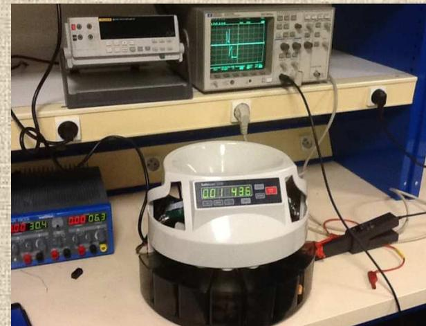
**Le courant est maximal quand le secteur denté est bloqué par le bâti, on mesure dans ce cas le courant.**
