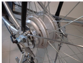
Moteur à courant continu à aimants permanents et réducteur
